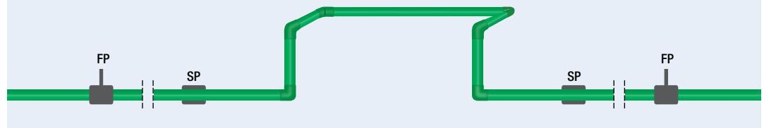
In caso di spazi ristretti, è possibile realizzare omega a sei gomiti come da disegno riportato. Il calcolo del braccio di flessione rimane lo stesso dei compensatori ad omega. Al fine di velocizzare le operazioni necessarie all'ottenimento delle lunghezze dei lati di curvatura, a seguire vengono riportati i grafici, per tutte le tubazioni della gamma fusio-technik, da cui è possibile ottenere il valore LB.
